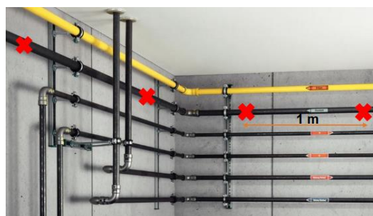
Příklad označení demontovaného potrubí/vedení nebezpečných látek
